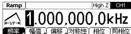
图 1-11 锯齿波常规显示界面
