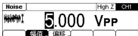
图 1-13 噪声波形常规显示界面
