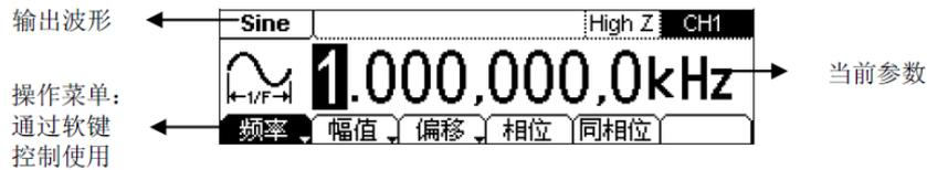
图 2-1 正弦波参数值设置显示界面
