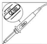
图 5 设定探头上的系数
