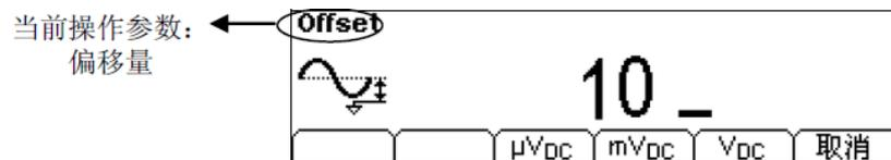
图 2-4 设置偏移量的参数值
