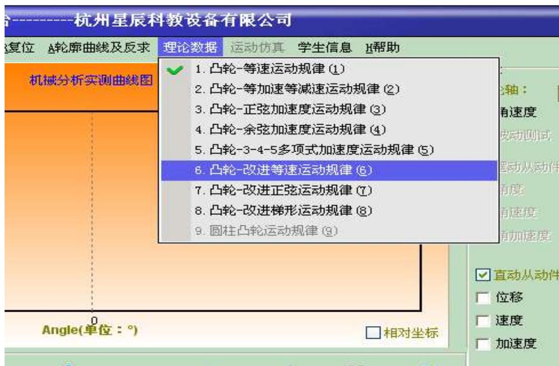
图 11 凸轮轮廓曲线类型选择界面
