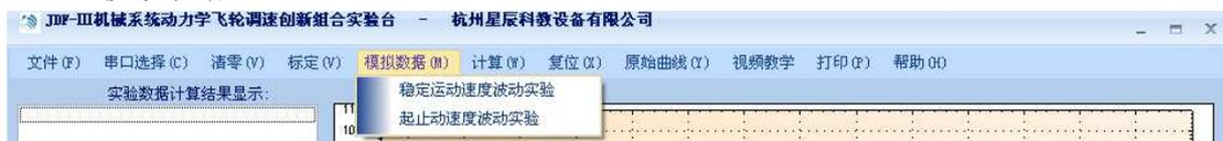
【模拟数据】提供两个数据项：**稳定运动速度波动实验** 和 **起止动速度波动实验**；它们是将采集的实验数据预存入软件中，方便在没有试验台的情况下可以通过这些实验数据来熟悉和了解飞轮台的工作情况。
