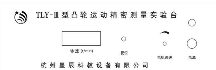
图 3 (a) 凸轮实验台操作台操作面
