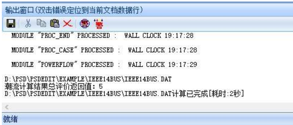
图 10-6 输出对话框显示潮流计算结果
