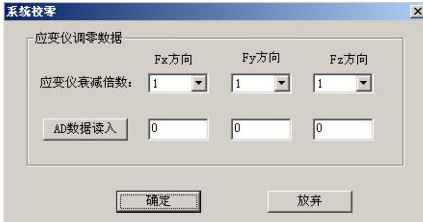
图3 系统校零的界面
