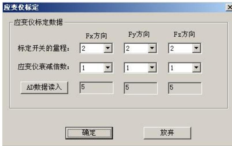
图4 应变仪标定的界面
