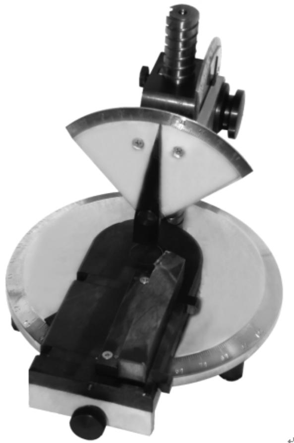
图 1. 车刀测角仪结构
